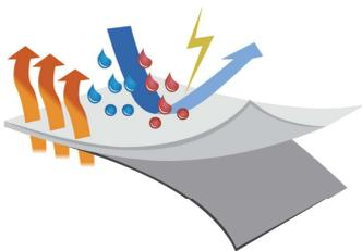
Película microporosa laminada a un sustrato de polipropileno.
