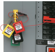
4. Para bloqueos grupales, corra la llave en múltiples aros en el riel de bloqueo y aplique los candados. ¡No es necesario usar cerrojos! (No se recomienda para uso con cerrojos de bloqueo múltiple)
