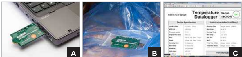
Ideal para supervisar lecturas de temperatura de alimentos, fármacos y otros productos de cadena de frío durante el transporte.
