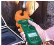
Compruebe la resistencia de red de torres de comunicación y móviles.
