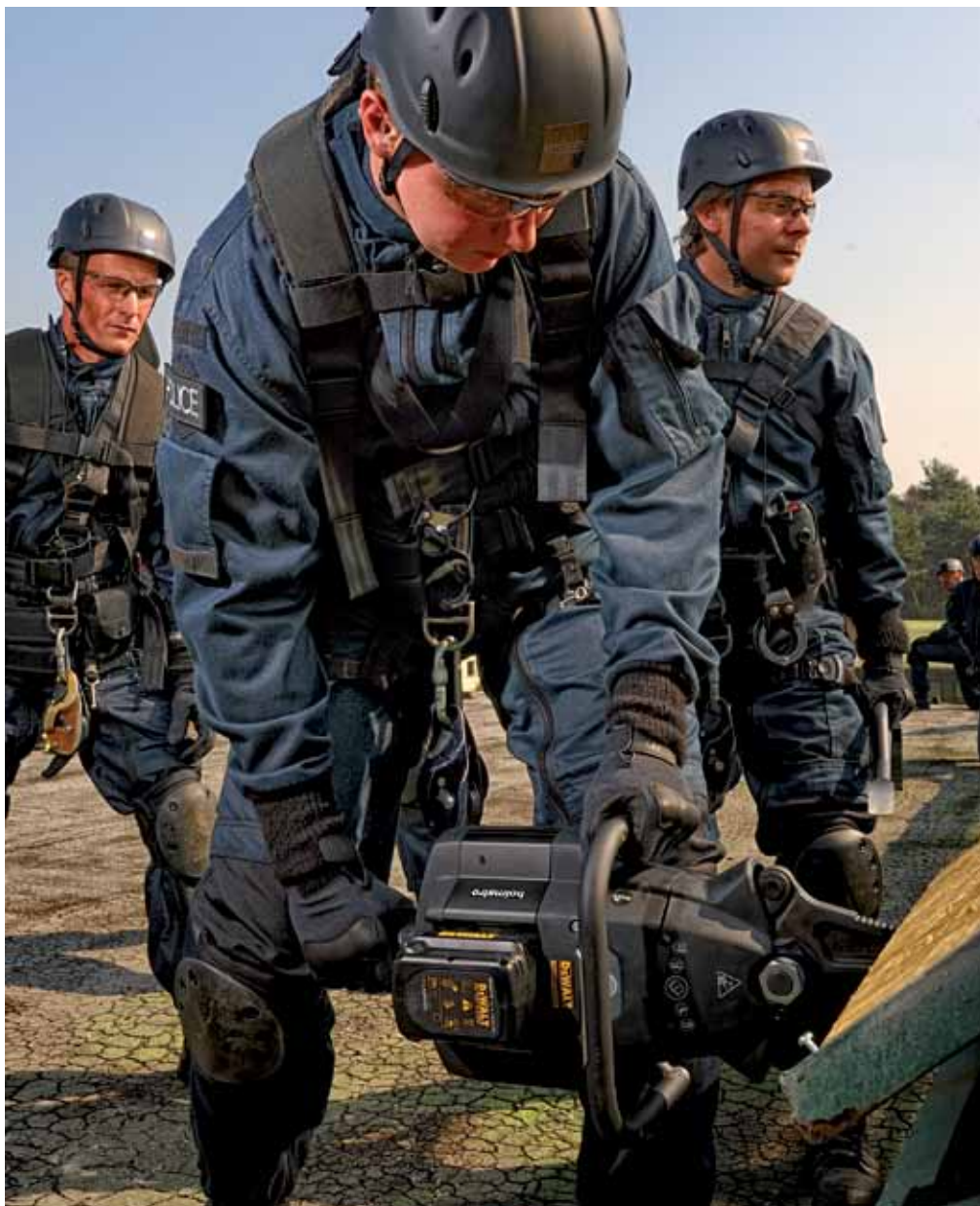
Separando una escotilla de un techo y cortando una barra de una ventana (ver página 8) con una herramienta combinada Holmatro operada por batería.
