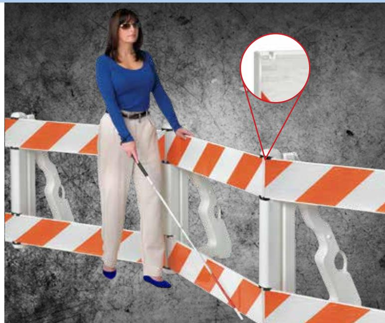
SafetyRail está diseñado para ser utilizado por el riel guía Wave® de PSS. El riel superior es uniforme, continuo y más seguro para la mano. El riel guía Wave inferior está a 1,5" del suelo, lo cual reduce la posibilidad de que las puntas de los bastones queden atrapadas. El diseño de "ranura" Wave (vea la imagen insertada) mantiene los rieles guía en forma segura en los casquillos.
