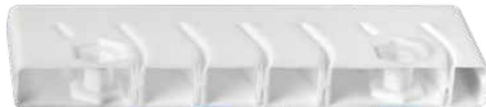
Figura B: Los orificios pasantes moldeados agregan resistencia y soporte. Los orificios retraídos admiten la colocación de elementos de ferretería al ras, lo cual protege a los instaladores y al laminado.
