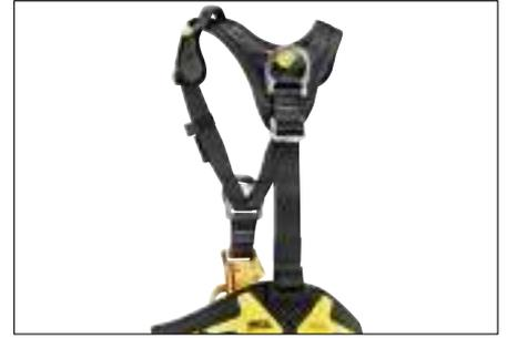
Los arneses completos ASTRO BOD FAST están provistos de un punto de enganche dorsal que permite conectar un sistema anticaídas. En caso de caída sobre este punto, una regulación corta de la longitud entre el cinturón y las perneras permite cargar el peso en las perneras y así poder estar más tiempo suspendido del arnés mientras se espera el rescate.
