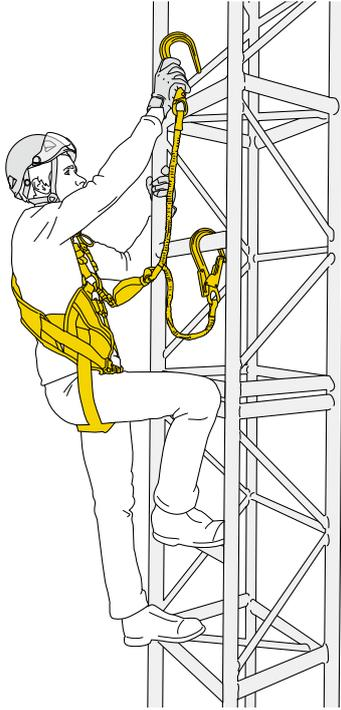
**ABSORBICA-Y FALL ARREST KIT****Kit para la protección contra las caídas con arnés NEWTON EASYFIT y elemento de amarre ABSORBICA-Y MGO 150**
