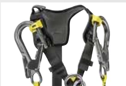
Los arneses disponen de un sistema para guardar los conectores de los elementos de amarre anticaídas en cada tirante. En caso de caída, este sistema permite el despliegue del absorbedor liberando el conector MGO.
