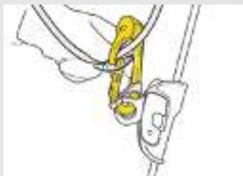
La polea ROLLCLIP A puede ser utilizada como punto de reenvío en un polipasto en combinación con el bloqueador RESCUCENDER.
