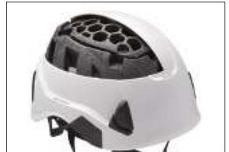
La almohadilla interior de los cascos STRATO está diseñada en dos partes: EPP (polipropileno expandido) y EPS (poliestireno expandido), con el fin de ofrecer más ligereza. La absorción de impactos se realiza por deformación de la almohadilla interior.
