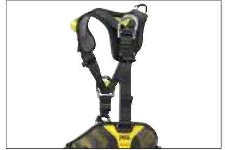
Los arneses completos AVAO BOD y AVAO BOD FAST están equipados con un punto de enganche dorsal que permite conectar un sistema anticaídas. En caso de caída sobre este punto, una regulación corta de la longitud entre el cinturón y las perneras permite cargar el peso en las perneras y así poder estar más tiempo suspendido del arnés mientras se espera el rescate.
